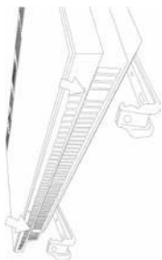
Obrázek 6. Nasazení konvektoru na spodní úchyt nástěnného závěsu
