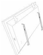
Obrázek 8. Připevnění horního pružinového úchytu, pohled zezadu
