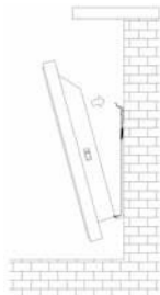
Obrázek 7. Připevnění horního pružinového úchytu na konvektor
