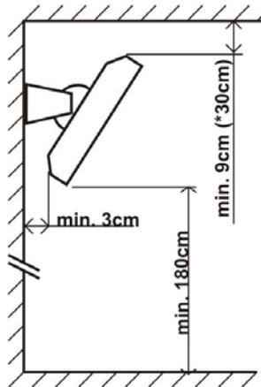
\* in staubiger und qualmiger Umgebung, wo die Gefahr der Deckenverunreinigung durch verbrannte Partikel besteht
