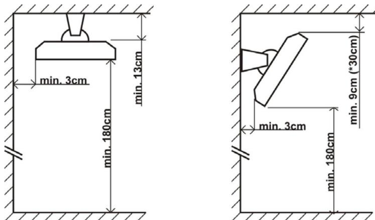
\* в пыльной и задымленной среде, где имеется опасность загрязнения потолка пережженными частичками
